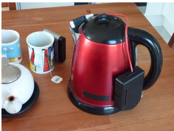
Figure 3. La bouilloire équipée de son boîtier et du capteur
