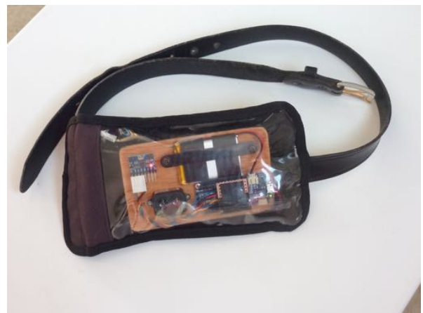
Figure 4. La ceinture et son matériel électronique dans une housse à face transparente
