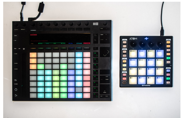
Figure 8: Contrôleurs MIDI utilisés pour la performance live : à gauche le Push 2 par Ableton (contrôle de la structure du morceau) et à droite ATOM par Presonus (contrôle de l'harmonie du morceau).
